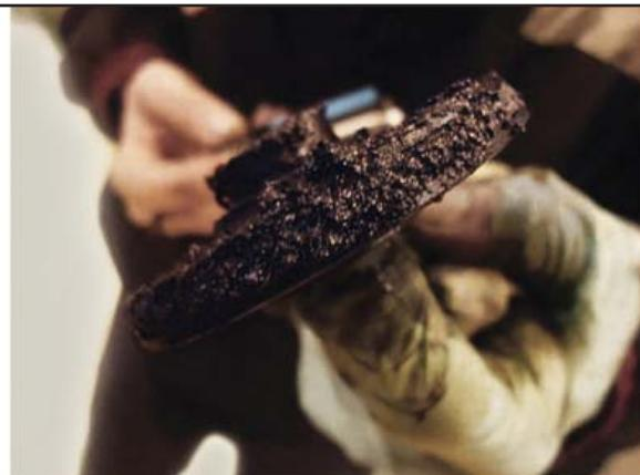
**Рис. 4. Детали ЭЦН WR2 после подъема установки (пример 1)**
