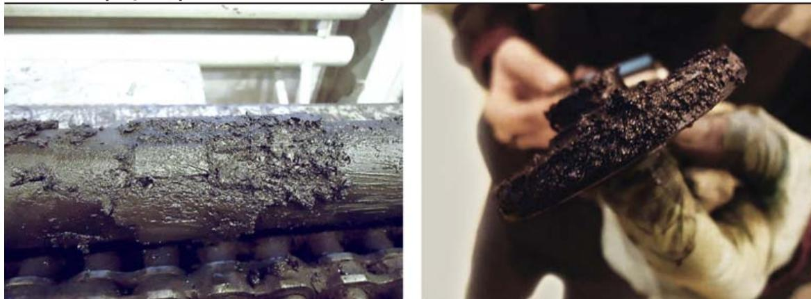
**Рис. 4. Детали ЭЦН WR2 после подъема установки (пример 1)**
